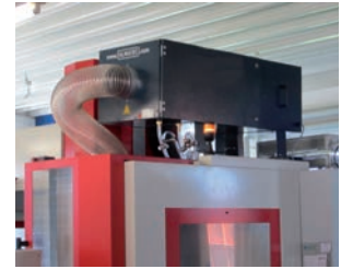
Ölnebelabscheider auf Bearbeitungszentrum installiert
