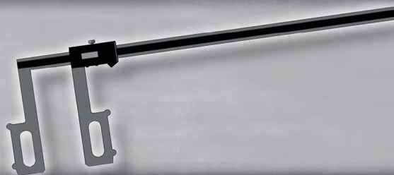
Sondermessschieber für Messungen an einer speziellen Werkstückkontur
